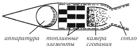
Сопло — суженная часть камеры, служит для увеличения скорости истечения продуктов сгорания, что, в свою очередь, повышает реактивную силу. Сужение струи газа вызывает увеличение его скорости, так как при этом через меньшее поперечное сечение в единицу времени должна пройти такая же масса газа, что и при большем поперечном сечении.
