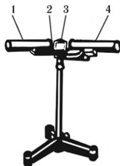
Так как показатель преломления зависит от длины волны, то пучок света, состоящий из волн с разной длиной волны, разлагается на параллельные пучки света разного цвета. Линза зрительной трубы фиксирует каждый пучок и дает разноцветные изображения щели, образуя разноцветную полоску — спектр.
