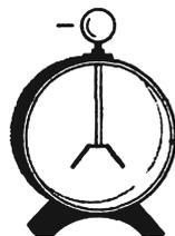
Для измерения зарядов можно использовать и *электромтр*. Основные части его — металлический стержень и стрелка, которая может вращаться вокруг горизонтальной оси. Стержень со стрелкой закреплен в пластмассовой втулке и помещен в металлический корпус, закрытый стеклянными крышками. При соприкосновении заряженного тела со стержнем стержень и стрелка получают электрические заряды одного знака. Стрелка поворачивается на некоторый угол.
