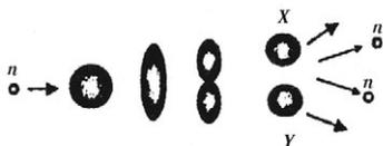
Под действием сил кулоновского отталкивания осколки разлетаются со скоростью, равной приблизительно  $1/30$  скорости света. Одновременно испускается излучение высокой частоты.
