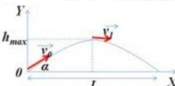
В верхней точке траектории полета скорость камня направлена горизонтально. При движении тела, брошенного под углом к горизонту, горизонтальная составляющая вектора скорости не меняется в течение всего полета:  $v_1 = v_0 \cdot \cos \alpha = \text{const}$ .
