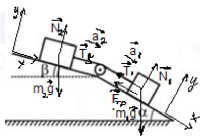
С учетом того, что нить легкая и нерастяжимая  $T_1 = T_2 = T$  и  $a_1 = a_2 = a$  второй закон Ньютона для каждого бруска в проекциях на ось 0Х по направлению их движения примет вид:
