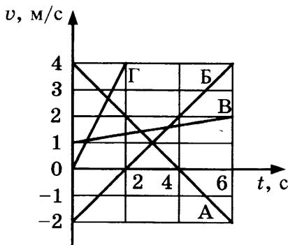
Какое тело движется с ускорением, равным по модулю  $1 \text{ м/с}^2$ ?
