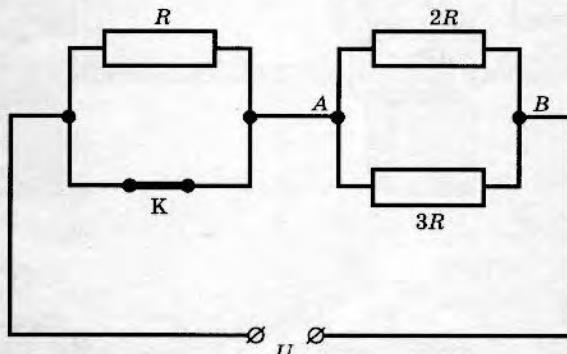
Определите, как изменяются при размыкании ключа следующие физические величины: общая сила тока в цепи и общее электрическое сопротивление цепи.
