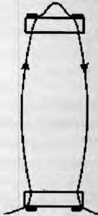
**Опыт 1. Взаимодействие проводников при пропускании через них электрического тока  $I_1$  в одном направлении**
