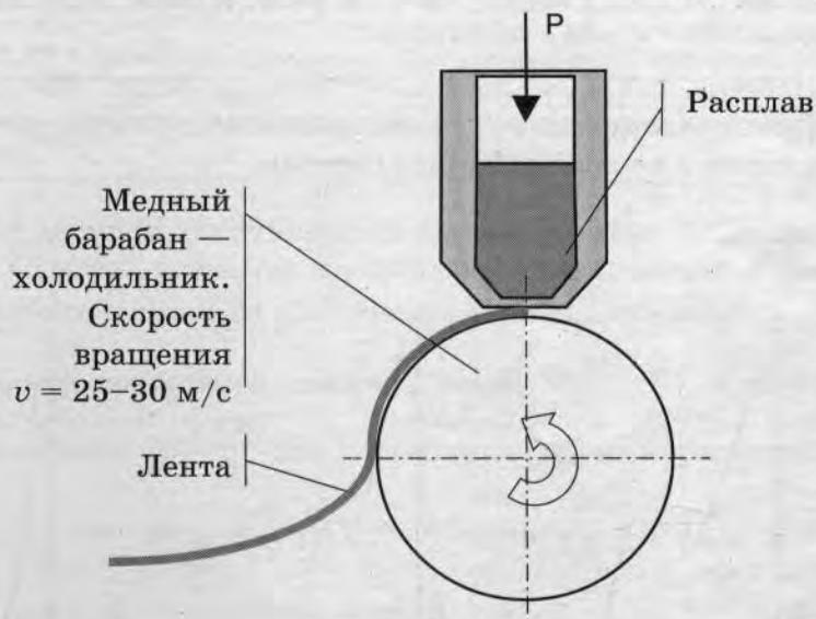
Рис. 1. Схема установки для получения аморфной металлической ленты.
