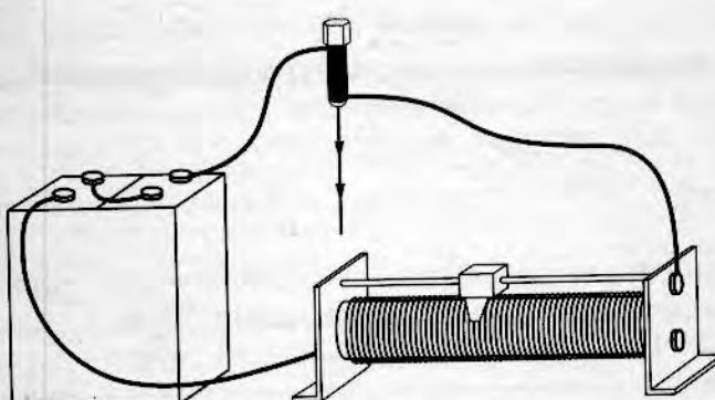
Как меняются общее сопротивление электрической цепи и подъёмная сила электромагнита при перемещении ползунка реостата влево?
