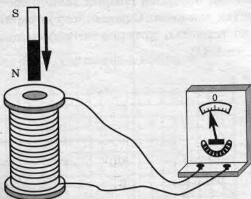
Если выносить магнит из катушки с большей скоростью, то показания гальванометра будут примерно соответствовать рисунку
