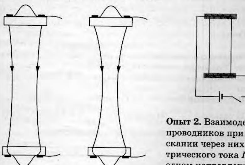
**Опыт 1.** Взаимодействие проводников при пропускании через них электрического тока  $I_1$  в одном направлении
