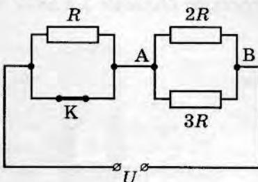
Сначала ключ  $K$  был разомкнут. Определите, как изменяются при замыкании ключа следующие физические величины: общая сила тока в цепи и общее электрическое сопротивление цепи.
