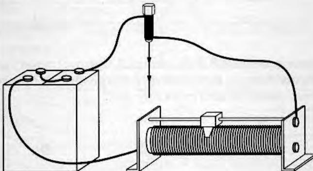
Как меняется общее сопротивление электрической цепи и подъёмная сила электромагнита при перемещении ползунка реостата вправо?
