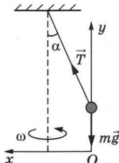
Здесь  $a_x = \omega^2 l \sin \alpha$  — центростремительное ускорение, где  $\omega = \frac{2\pi}{\tau}$  — угловая скорость груза.
