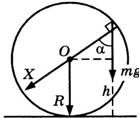
В точке отрыва сила нормальной реакции опоры равна 0:  $N = 0$ . Центростремительное ускорение шайбы  $a_{\text{цс}} = \frac{v^2}{R}$  найдем из второго закона Ньютона (см. рис.):
