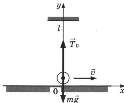
При прохождении положения равновесия нить обрывается, и шарик, движущийся горизонтально со скоростью  $v$ , абсолютно неупруго сталкивается с покоящимся бруском. При столкновении сохраняется импульс системы «шарик + бруском».
