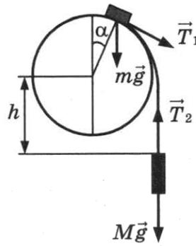
Груз  $m$  в точке отрыва ещё движется по окружности радиусом  $R$ , но уже не давит на сферу. Поэтому его центростремительное ускорение вызвано только силой тяжести, так как сила  $\vec{T}_1$  направлена по касательной к сфере (см. рисунок):
