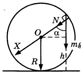
Центростремительное ускорение шайбы  $a_{nc} = \frac{u^2}{R}$  найдем из второго закона Ньютона
