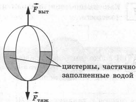
Схематическое изображение сечения подводной лодки
