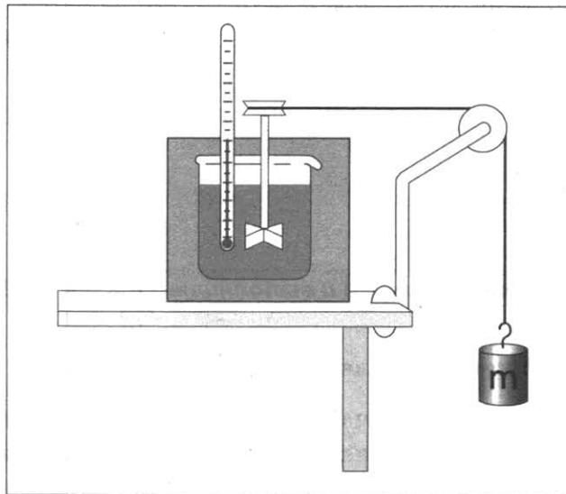
Рис. 2. Упрощённая схема опыта Джоуля
