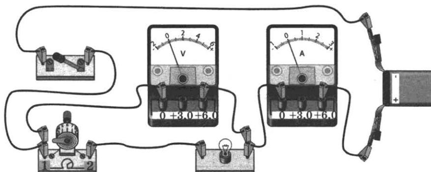
Какие приборы — амперметр и (или) вольтметр — включены в электрическую цепь правильно?
