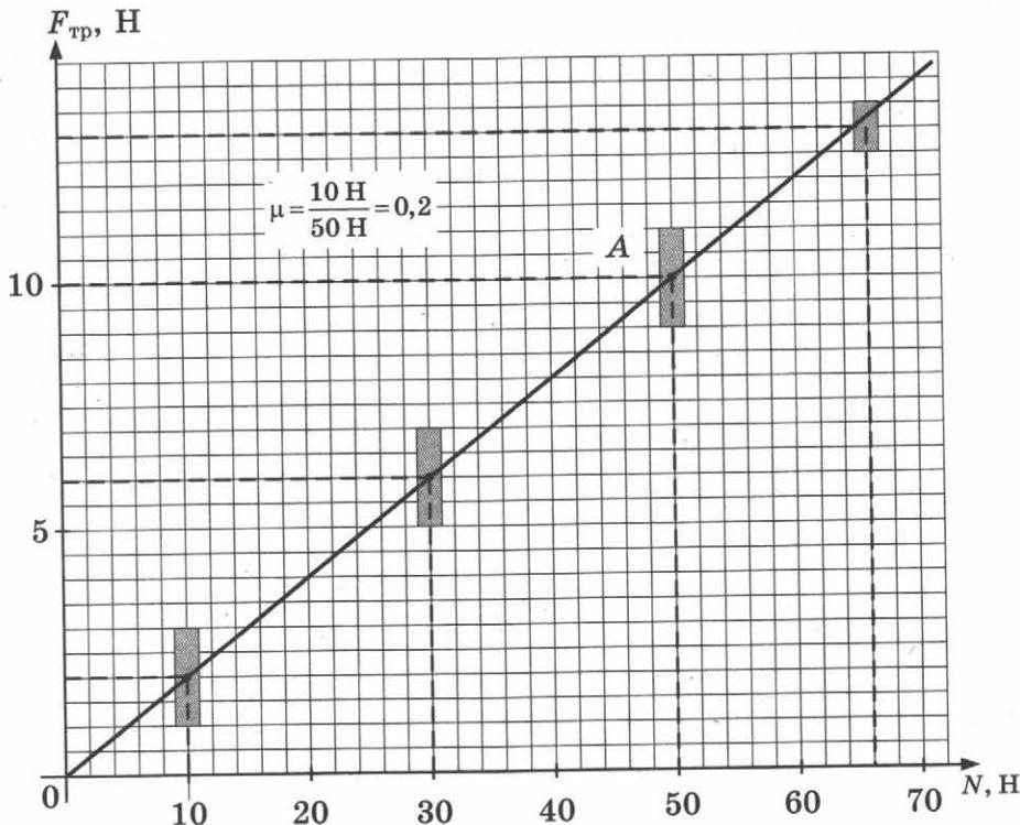
Правила определения коэффициента пропорциональности при исследовании зависимости типа  $y = kx$ :
