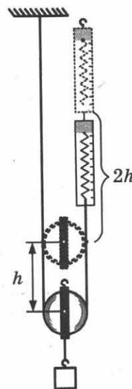
Работа силы упругости равна  $A_{F_{упр.}} = 1,6 \text{ Н} \cdot 0,4 \text{ м} = 0,64 \text{ Дж.}$
