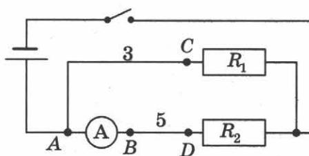
Амперметр снова измеряет общий ток. Теперь конец *B* провода 3 переключите к точке *A* (рис. *г*). Амперметр измеряет силу тока в резисторе  $R_2$ . Запишите его значение:
