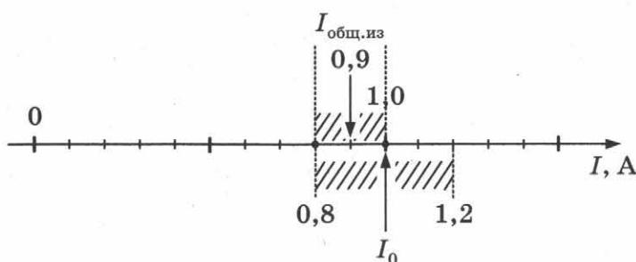
**Вывод:** Правило подтверждается, так как интервал измеренного значения силы общего тока и интервал суммы сил токов пересекаются.
