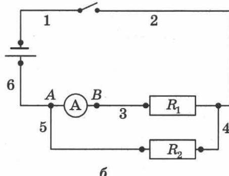
Амперметр в этой цепи измеряет общий ток  $I_0 = \underline{\hspace{2cm}}$  А.
